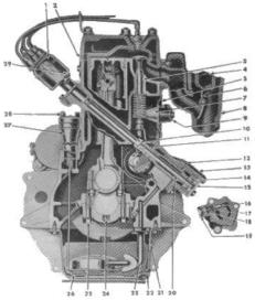
FIG. 4 -- END SECTIONAL VIEW OF ENGINE
